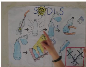
SODIS steht für \*SO\*lar Water \*DIS\*infection. Es handelt sich dabei um eine effektive und einfache Möglichkeit aus vorhandenen Ressourcen Trinkwasser herzustellen. Mit Hilfe von PET-Flaschen, die man auch in Kenia massenweise am Straßenrand finden kann, wird das Wasser mit Sonnenlicht desinfiziert.
